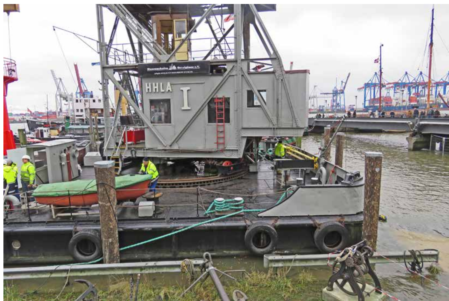
Eine Ansicht des schwenkbaren Kranaufbaus, welcher sich auf einem kreisrunden Drehkranz befand. Durch den Drehkrank konnte der ausschwenkbare Kranarm genau in jede Richtung gedreht werden
